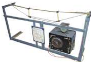
Рис. 5. Автоматическое управление напряженно-деформированным состоянием шпрингельной балки (патент № 2010345)
