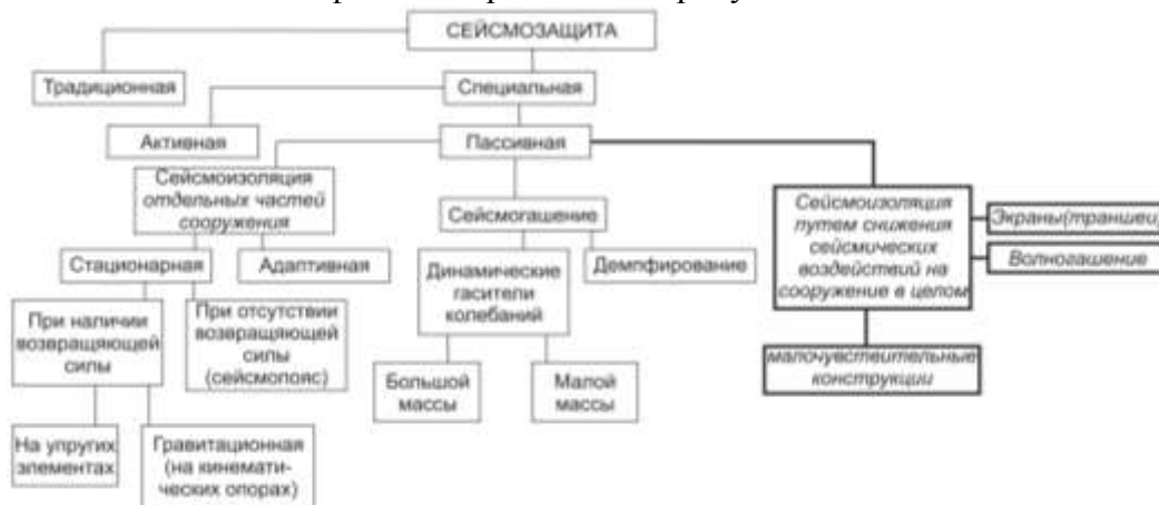
Рисунок 2. Дополненная классификация систем сейсмозащиты по принципу их работы (курсивом выделены дополнения).
