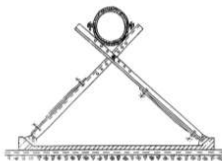
Рис. 3. Регулируемая опора надземного трубопровода для строительства в сложных грунтовых условиях. Патент № 41829
